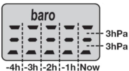
Das Balkendiagramm im Barometer-Hauptmenü stellt die Luftdruckentwicklung der letzten 4 Stunden dar und erlaubt so eine Wettervorhersage. Das Diagramm vergleicht die vor 4, 3, 2 und 1 Stunde gemessenen Luftdruckwerte mit dem aktuellen Wert. Eine Balkenhöhe entspricht 3 hPa (3 mbar).
