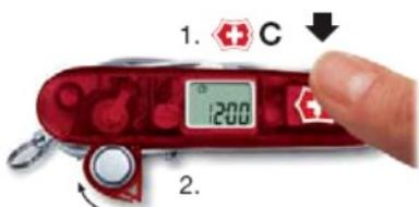
Durch Drücken des Victorinox-Emblems während des Schliessens des Batteriefaches wird das amerikanische Einheitensystem (Höhe = ft, Temperatur = °F, Zeitmodus = 12h) eingestellt. Der Funktionstest erfolgt gleich wie oben beschrieben.
