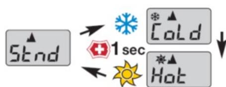
Die Anzeige wechselt anschliessend in den "Wetterkorrektur-Modus". Wird das Victorinox-Emblem kurz gedrückt, kann die Korrektureinstellung in der Reihenfolge "Stnd", "Cold", "Hot" geändert werden.
